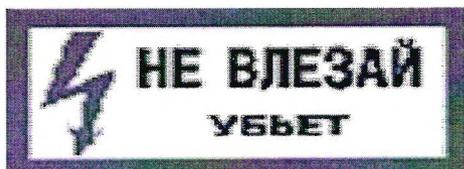
Для предупреждения об опасности подъема по конструкциям, при котором возможно приближение к токоведущим частям, находящимся под напряжением
